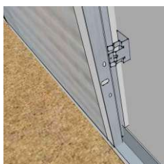
Zasunutie panelu a T profilu do závesu
