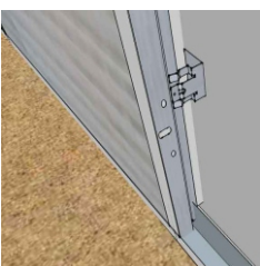
Zasunutie panelu a T profilu do závesu
