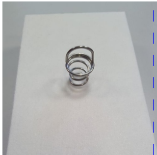
Zakrútenie drôteného háku do tela panelu
